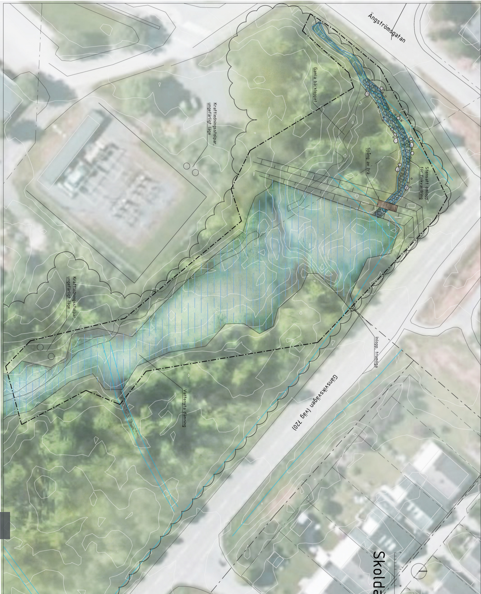
FIGUR 14 Skiss över damm vid Gerestaskolan. Utloppet har en anpassad lutning, för att undvika att vandringshinder skapas.
